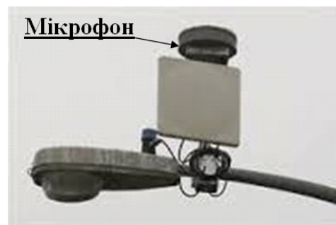
Рис. 9. Елемент акустичної системи ShotSpotter (США)
