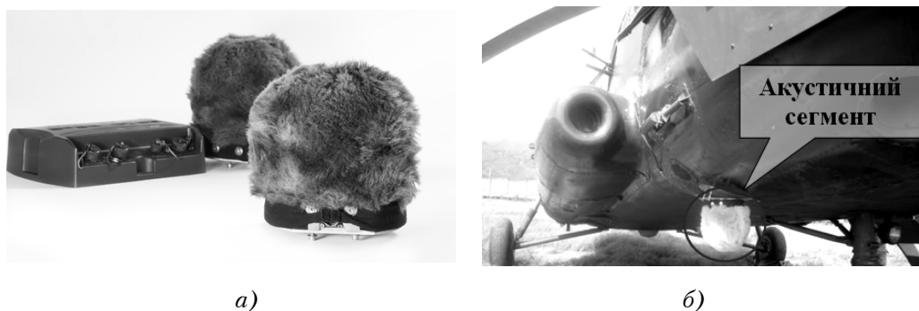
Рис. 2. Французька акустична система виявлення пострілу для гелікоптерів Pilar-HV : а) акустичний сегмент; б) приклад встановлення акустичного сегменту на гелікоптері
