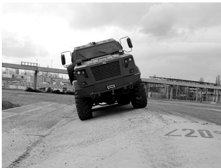
Рис. 4. Подолання перешкоди “Косогір” з поперечним ухилом 20° і довжиною 15 м бронев автомобілем “КрАЗ–Shrek”
