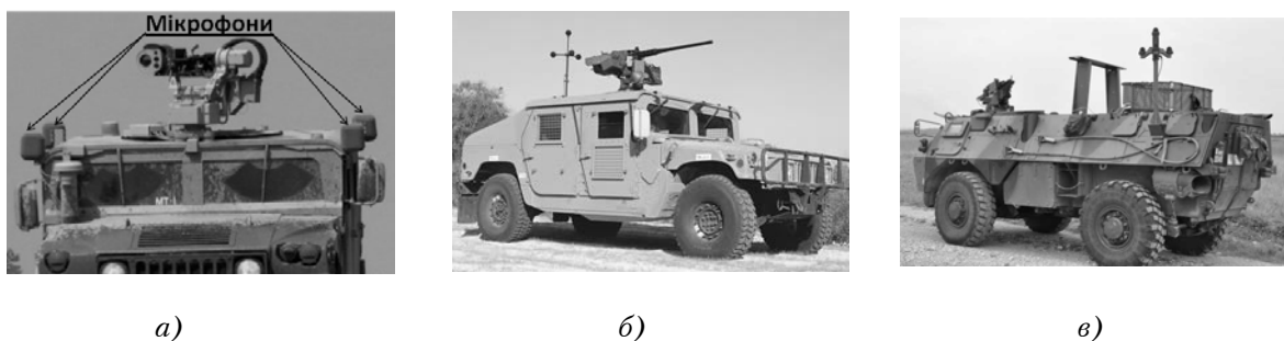
Рис. 5. Мобільні акустичні системи виявлення пострілу, які забезпечують одночасний аналіз БХ та ДХ: а) PDCue (ФРН); б) Rafael (Ізраїль); в) Pilar V (Франція)
